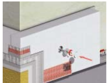
Aufbau des Wärmedämm-Verbundsystems Star mit EPS-Fassadenplatten.
