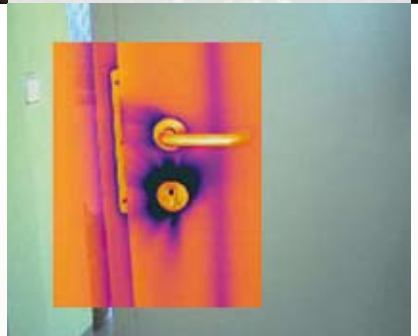
Luftundichtigkeiten in der Tür mit erheblichem Temperaturunterschied
