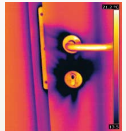
Luftundichtigkeiten in der Tür mit erheblichem Temperaturunterschied
